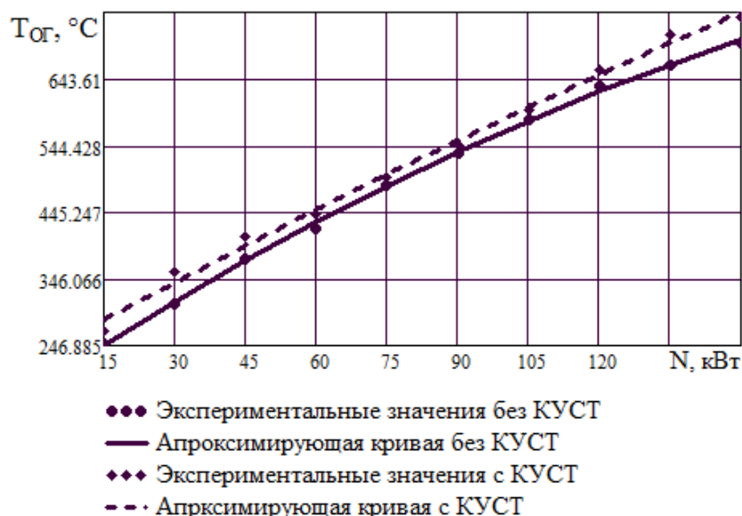
Рисунок 3 – Зависимость температуры ОГ от используемой мощности ДВС
