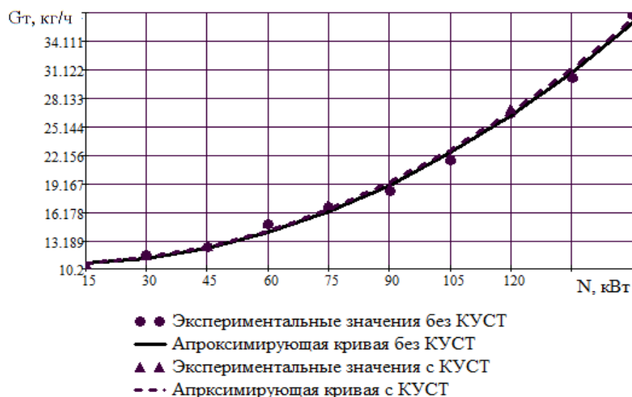
Рисунок 2 – Зависимость расхода топлива от используемой мощности ДВС
