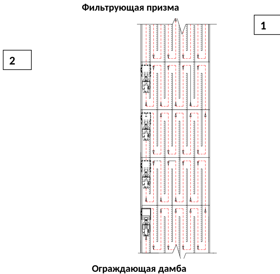
Рисунок 2 Схема уплотнения хвостов пляжной зоны.
